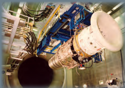
Der Erstlauf des BR715 Triebwerks auf dem Prüfstand
